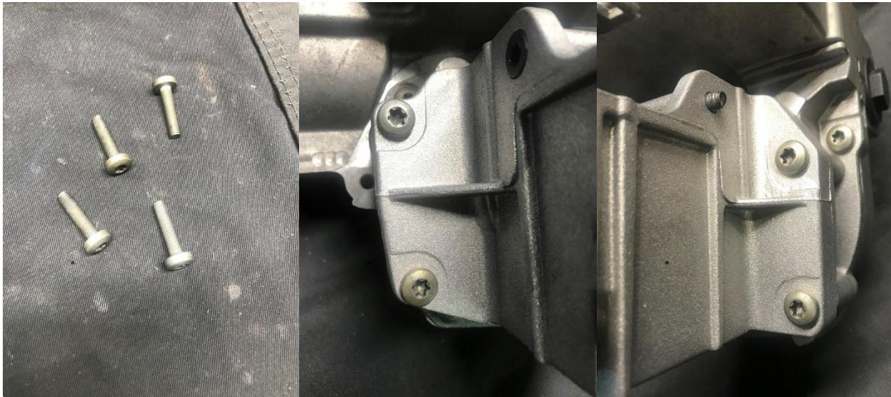
Bevestig de behuizing aan de zijkant en de achterste beugel met de bouten.
