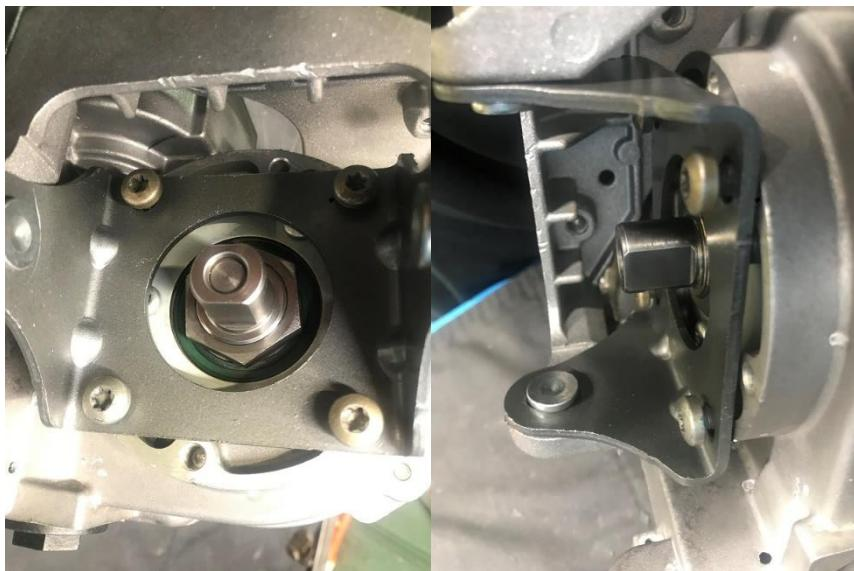
Zet de behuizing handvast met de moer in de onderstaande foto.
