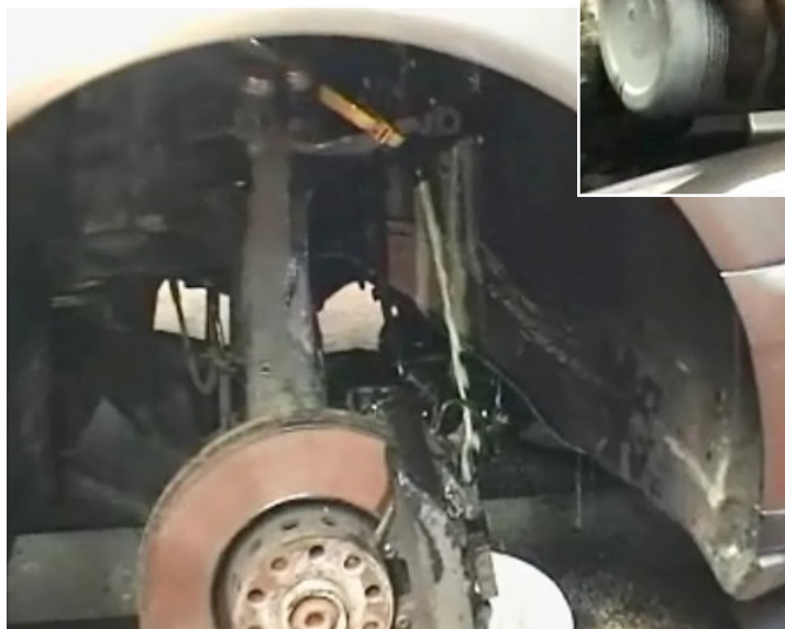
Bij het spoelen wordt de motor gestart terwijl een tweede persoon de olie blijft bijvullen tot er propere olie uit de hogedrukleiding komt
